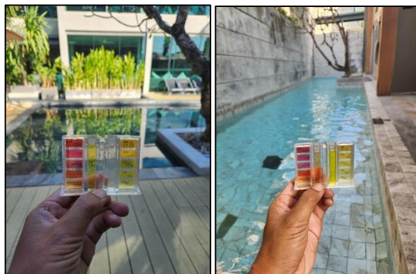
รูปที่ 3-36 เจ้าหน้าที่ตรวจวิเคราะห์ปริมาณคลอรีนและความเป็นกรด-ด่างของน้ำในสระว่ายน้ำ
