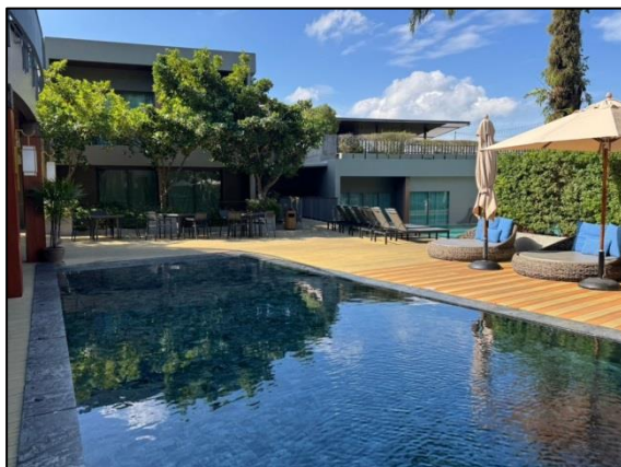
รูปที่ 3-33 พื้นที่ว่างเป็นทางเดินรอบสระว่ายน้ำ ความกว้างไม่น้อยกว่า 1.20 เมตร ไม่ลื่น ไม่มีน้ำขัง และสามารถทำความสะอาดง่าย
